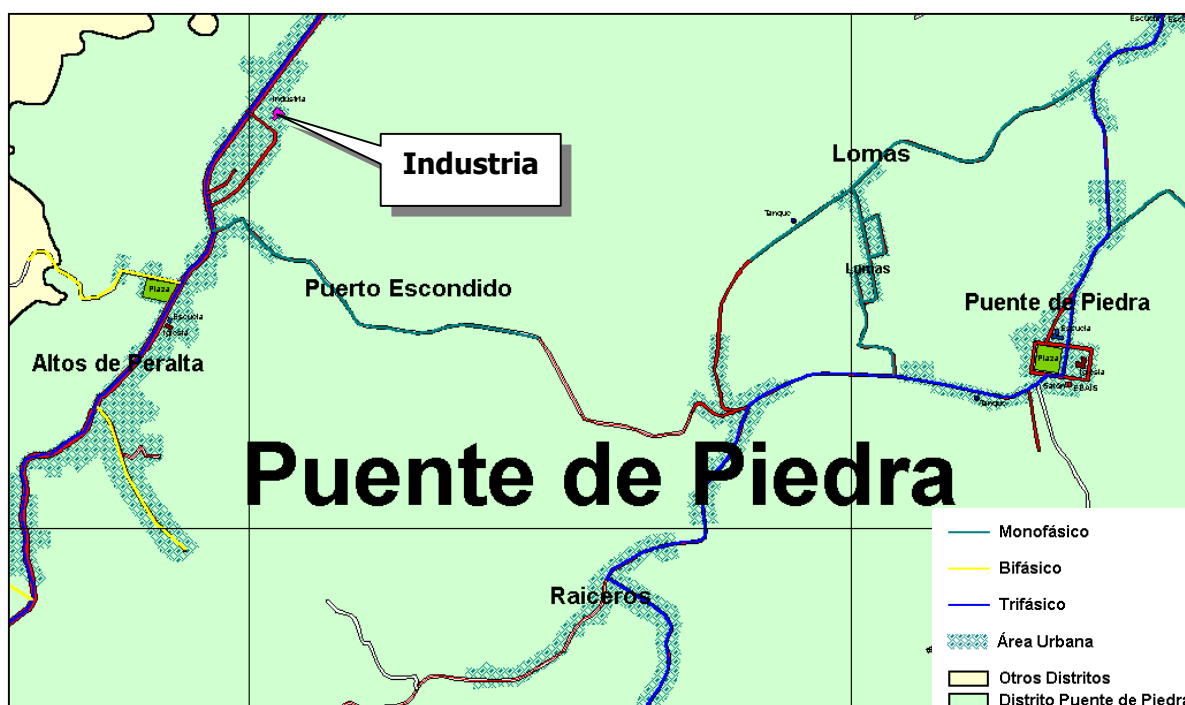
Figura 28. Tipos de líneas eléctricas en el distrito Puente de Piedra
